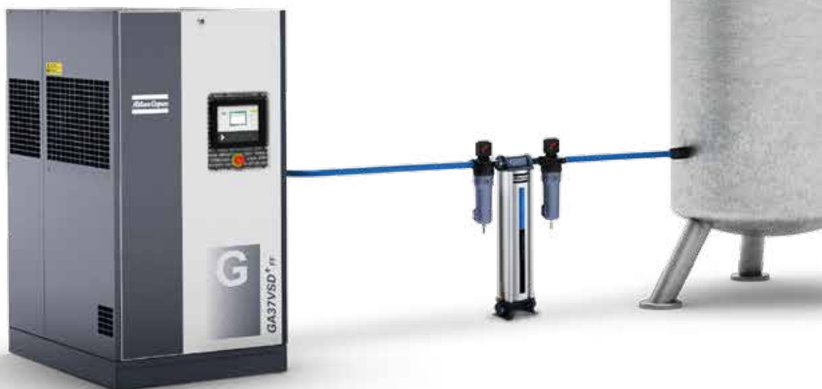
En vanlig installation: kompressor med integrerad tork, förfilter UD*, QDT-torn med aktivt kol, dammfilter, behållare, NGP*-kvävegenerator, behållare.
